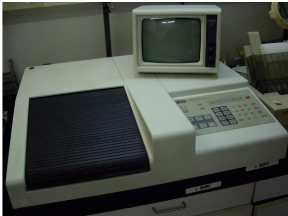
**UREĐAJ:** Laserski denzitometar
